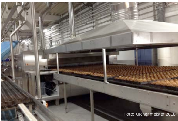
Abb. 4: Auslauf des variablen Thermoöfens. Hersteller: Kornfeil
